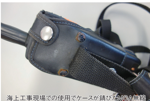
海上工事現場での使用でケースが錆びたMCA無線
