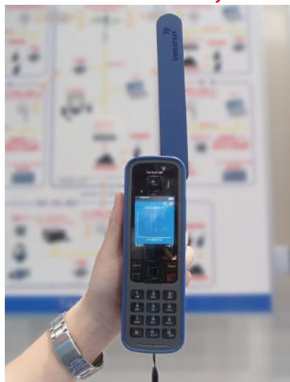
本体についている小型アンテナを回転させて使用します。
