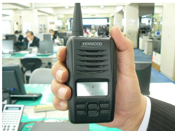
緊急支援させていただいた業務用デジタル簡易無線機。通信距離2~3km、最大約5kmの範囲で通信可能。寸断された被災現場の復旧復興を全力で応援しています！
