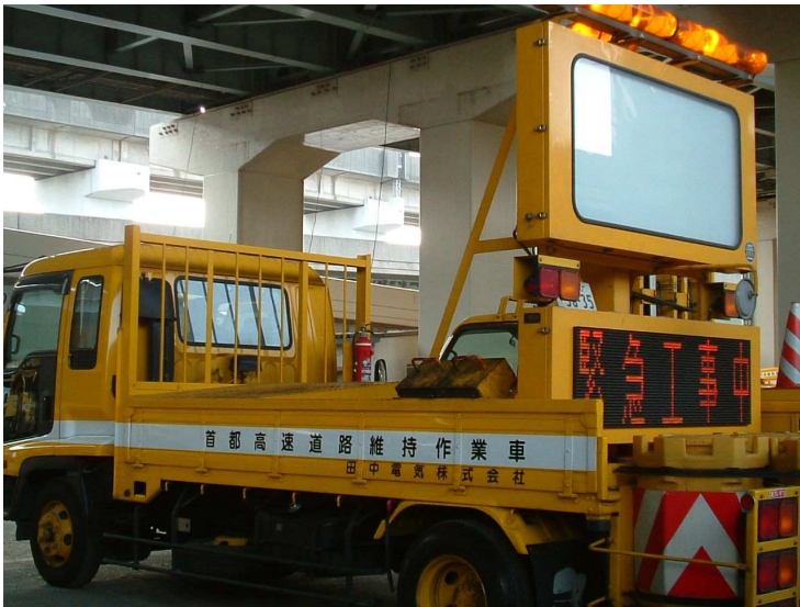
首都高速道路工事作業中の注意を促す規制車
