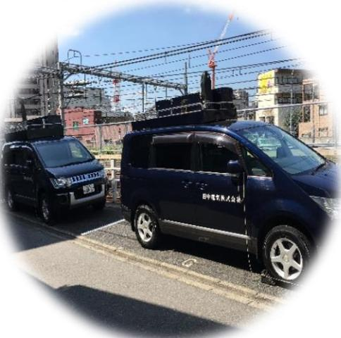
田中電気には登録検査時に必要となる電界強度測定車※を**2台所有**しております。電測ポールは最大12mも伸びます。
