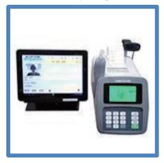
呼気アルコール測定システムは呼気アルコール測定器と連動させ、測定結果をデータとして管理することができるアプリケーションソフトおよび、カメラを含むシステム機器です。
