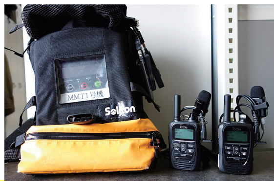
「モバイル中継」システムの例 「Smart Telecaster Zao」とIP無線機
