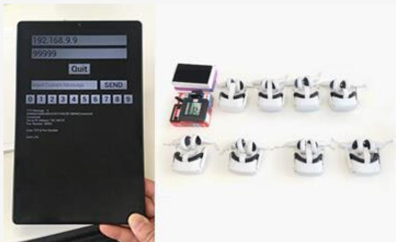
「同時再生システム」は、映像端末（VRゴーグルまたはスマートフォン）にインストールされたコンテンツをWI-FIを介して同時に再生させるシステムです。これにより、複数人が同じコンテンツを同時に視聴することができます。
