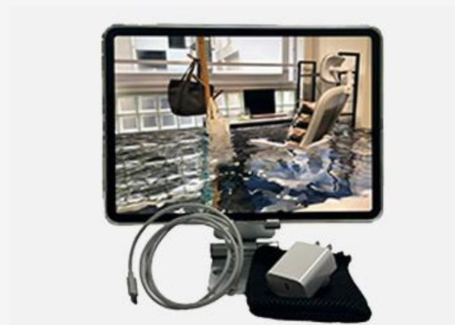
タブレットに内蔵されているアプリを用いて、誰でもどこでも実空間が浸水・氾濫した状態を再現することができます。
